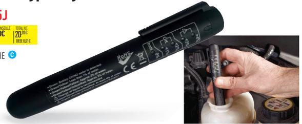
Testeur électronique de liquide de frein. Vérifie la quantité d'eau contenue dans le liquide de frein testé. Utilisable avec les liquides de frein DOT 4. 5 leds indiquent la quantité approximative d'eau contenue dans le liquide testé : 0%, 1%, 2%, 3%, 4%. Conçu en fibre de verre renforcé évitant ainsi une usure prématurée ou un endommagement de l'appareil par contact du liquide de frein. Contient une pile de 1.5V type AAA. Dimensions : 8.7cm x 2.8cm x 1.18cm (L x l x h)
