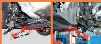
Levier composé de : 1 bras + 1 tampon pour un appui sous caisse, 1 bras articulé de traction, 1 vis de traction. Fonctionnement : En se positionnant sous la caisse du véhicule, ce levier permet la traction du bras de suspension et/ou du moyeu afin d'extraire la jambe de force de l'amortisseur et de dégager la rotule inférieure. Opération réalisée en sécurité.
