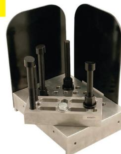
Conçu pour offrir une base d'appui réglable et stable pour moyeux de véhicules et d'autres formes compliquées pour permettre l'extraction des roulements. Fourni avec 4 colonnes en acier à longueur réglable avec des entretoises d'angle amovibles. Le bloc métallique est pré-percé et fileté et livré avec un ensemble de goujons permettant de former un ensemble de points de supports.
